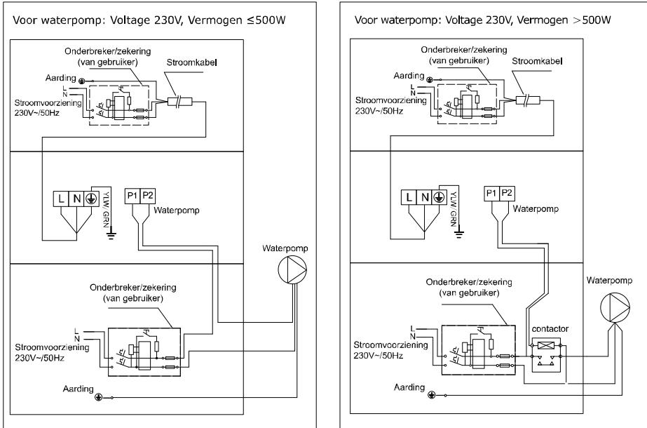
Parallelle verbinding met filtratieklok
