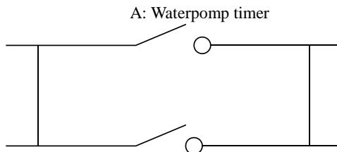
Opmerking: De installateur moet A parallel met B verbinden (zoals op de tekening hierboven). Om de waterpomp te starten: A of B is verbonden. Om de waterpomp te stoppen zijn A en B allebei ontbonden.
