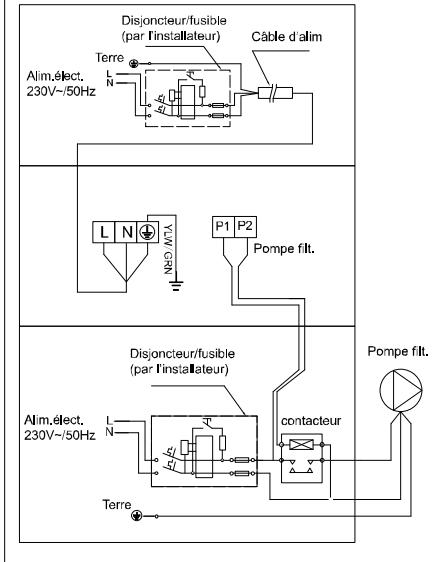
Connexion en parallèle avec l'horloge de filtration
