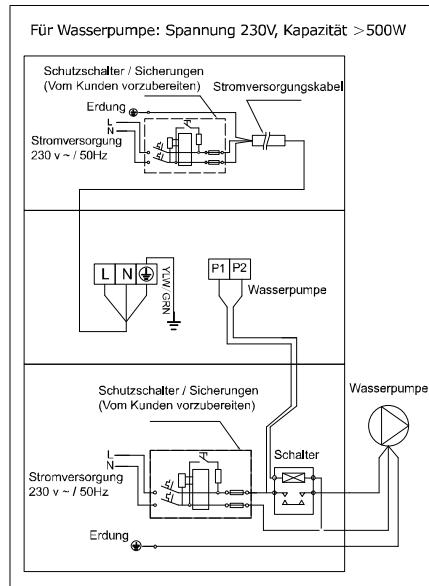
Parallelschaltung mit Filteruhr
