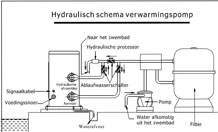
(Opmerking: dit schema wordt ter referentie weergegeven. Het weergegeven hydraulische circuit is slechts een basis.)
