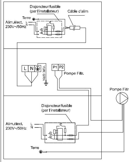
Pour pompe filtration: Voltage 230V, Capacité >500W
